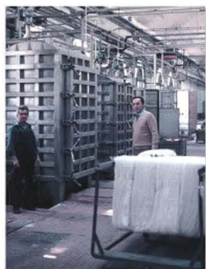
Anni '90, Lanificio di Ponte Felcino: batteria di armadi per tintura in matasse.
