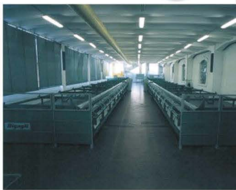
Anni '80, Lanificio di Ponte Felcino: reparto filatura. Nella fase della filatura, il macchinario esegue in rapida successione tre diverse operazioni: lo stiro, la torsione e l'incannatura del filo.
